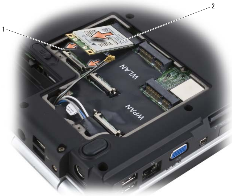
1 Lengüetas metálicas de fijación (2) 2 Tarjeta WWAN
